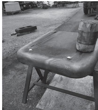
Und so sieht der Rohling für die Feuerbüchsenrohrwand fertig aus
