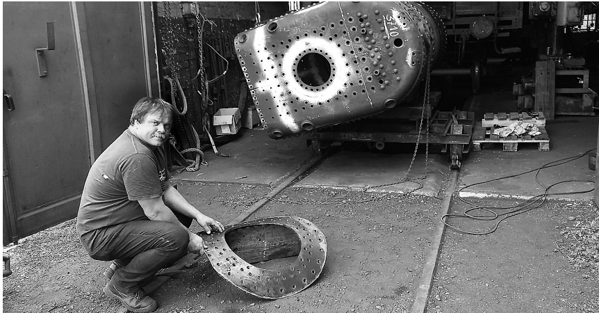
Der Dampfdomkragen muss in drei Dimensionen angepasst werden.
