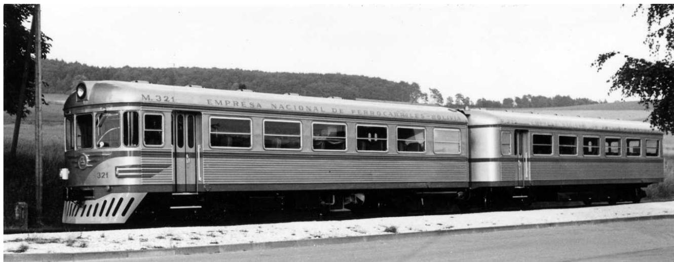
unterschiedlichen Stoßdämpfern. Von der Firma Voith stammte die Kühlanlage. Als Getriebe war ein Schaltgetriebe von ZF eingebaut. Am 2. August 1967 fand zum Abschluss der Fahrten eine Vorführfahrt für geladene Gäste statt.
