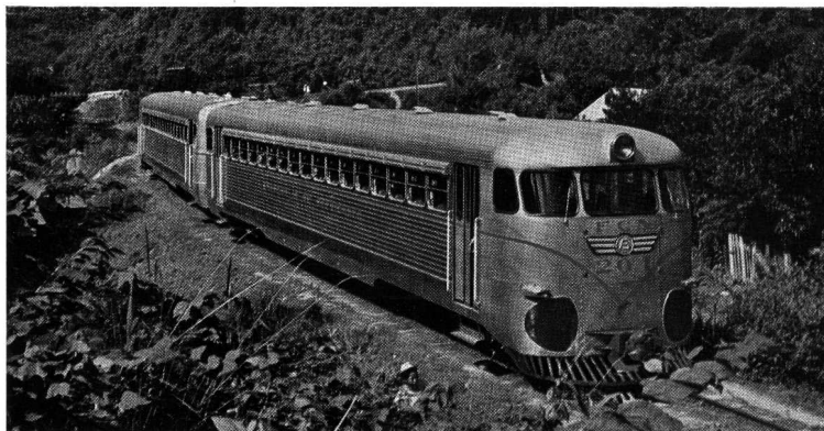
Vierachsiger Leichtbau-Dieseltriebwagen mit Nirosta-Außenverkleidung, ausgerüstet mit MAN-Dieselmotoren, zweimal 200 PS, vollautomatischen hydromechanischen VOITH-Kraftübertragungen, Druckluftbremse und 2 Schwingachs-Drehgestellen pro Wagen; Höchstgeschwindigkeit 80 km/h, 85 Sitzplätze je Wagen. Geliefert nach Honduras.
