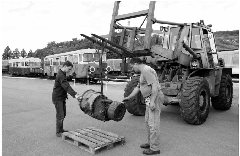
**Zwei mal DIWAbus-Getriebe: 1956 warb Voith mit dem Triebwagen T 01 der Wüna für die Getriebebauart. Am 1. August 2009 wurde eines der beiden DIWAbus-Getriebe des Triebwagens T 37 zur Aufarbeitung ausgebaut. Fotos: Sammlung HMB, Werner Kuhn**
