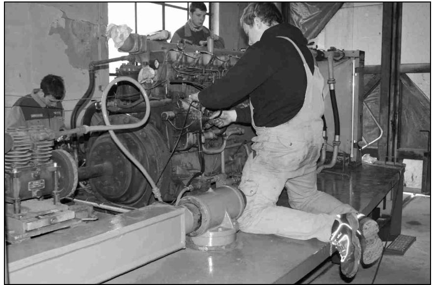
Auszubildende der Firma Voith arbeiten an der Verkabelung der Diesellokomotive JUMBO Foto: Ernst Schwarz
